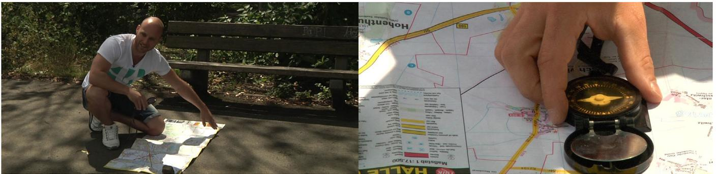
Beim Einnorden wird eine Karte, ein Plan oder ein Luftbild so ausgerichtet, dass die darauf dargestellten Richtungen parallel zu den entsprechenden Richtungen im Gelände verlaufen. Karte und Gelände sind dann gleich orientiert, insbesondere zeigt die Nordseite der Karte nach Norden. Das Einnorden erleichtert den Vergleich von Karte und Gelände, es ist auch Voraussetzung für einige Verfahren der Kartenarbeit mit dem Kompass.
